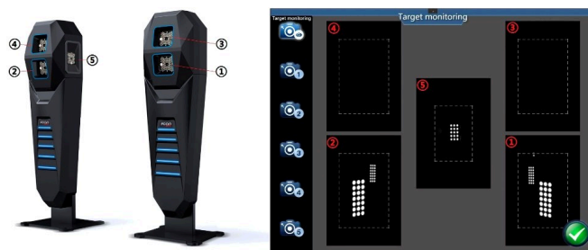
Figura 6.5-2 Posición de cada cámara
